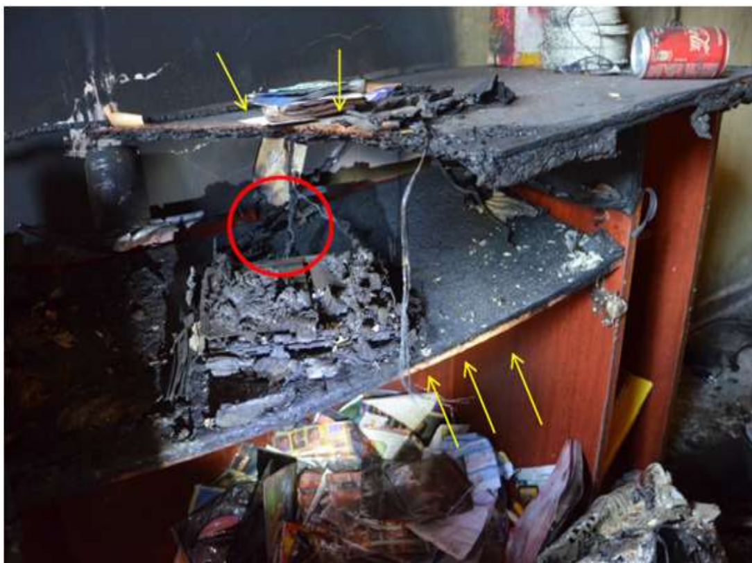
Figura 2. Padrão de queima na madeira ( Fonte: Arquivo pessoal dos autores ).
